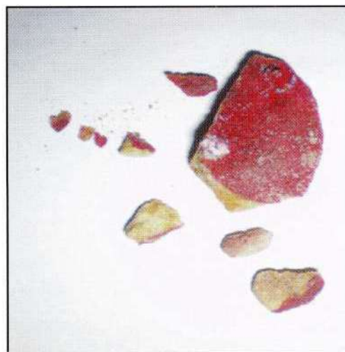
Figure 5 : Grain de grès avant et après écrasement à l'essai œdométrique.
